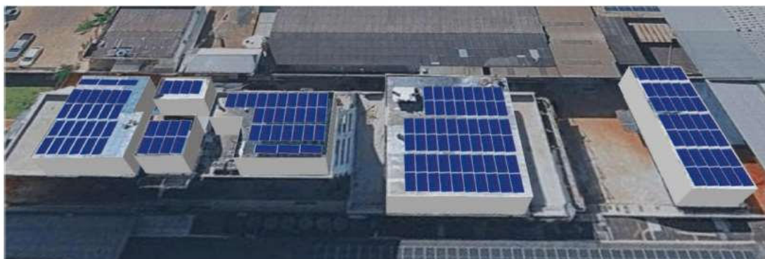
Imagem 01: Distribuição proposta dos 157 módulos fotovoltaicos na cobertura do edifício – área útil disponível de 585 m².
