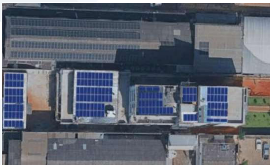
Imagem 02: Distribuição proposta dos 157 módulos fotovoltaicos na cobertura do edifício – área útil disponível de 585 m².
